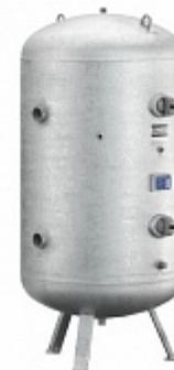
Воздушный ресивер Atlas Copco LV 211 объёмом 250 литров можно устанавливать после компрессоров, которые подают сжатый воздух при давлении не более 11 бар. Как правило, этот воздухохранилище устанавливают после поршневых или винтовых компрессорных установок. Ресивер LV 211 не попадает под обязательную регистрацию в Ростехнадзоре.
