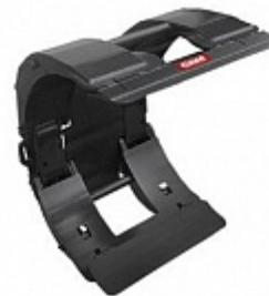
Раздельная длинная лапа позволяет одновременно работать с двумя бумажными рулонами разного диаметра. Подвижная короткая лапа позволяет обрабатывать рулоны в широком диапазоне диаметров. Противоударный ограничительный клапан на каждом цилиндре. Более тонкий профиль лапы и передача максимального захватного усилия на контактные накладки. Новые геометрические пропорции компонентов захвата и улучшенный обзор сквозь лапы. Система вращения на 360°.
