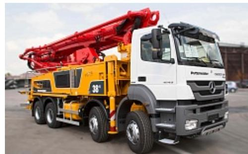
Высота подачи 37,5 м на трехосном шасси, при этом 5 секций распределительной стрелы, для еще большей гибкости. RZ-тип складывания стрелы Вес- до 27 тонн: Допускается для проезда по дорогам общего пользования РФ, не требуется получение специального разрешения.
